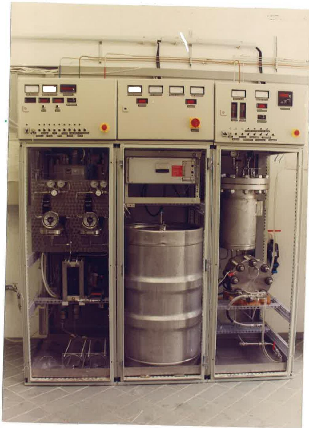
**Brennstoffzelle und Elektrolyseur im Wasserstofflabor der FHW**
