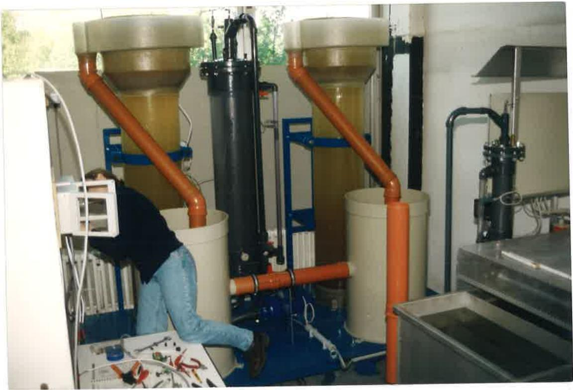
**Dezentrale Kläranlage mit Sauerstoff aus Elektrolyseur**
